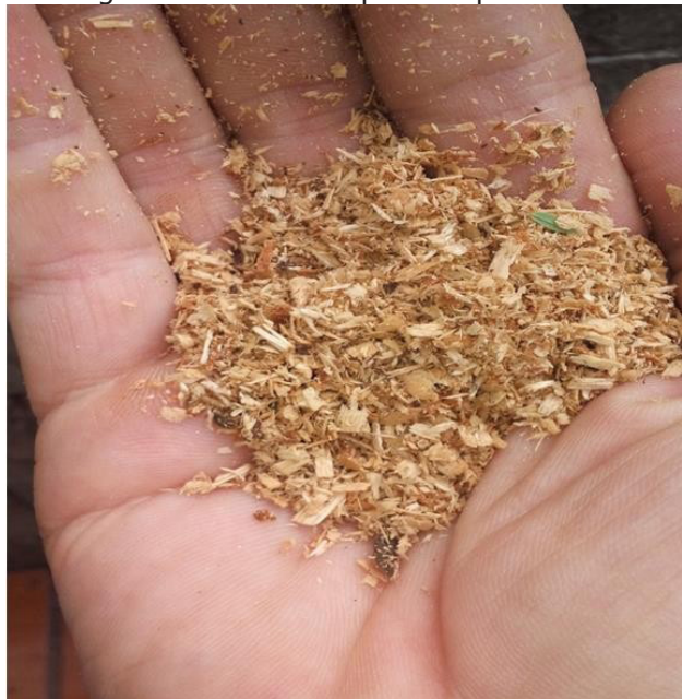
Figura 8: cavaco depois de peneirado.
