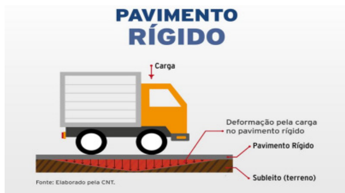
Figura 6 – Distribuição dos esforços no pavimento rígido Fonte: CNT (2017)
