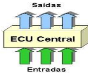
Figura 1 Arquitetura centralizada Fonte: Guimarães (2007)
