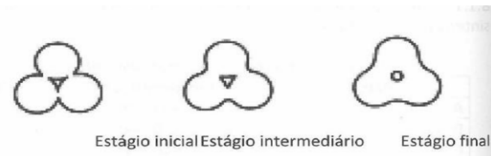
Figura 4: Estágios do processo de sinterização Fonte: LOBERTO; GENOVA; SILVA, (2009).
