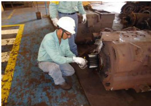
Figura 7 - Desmontagem manual do motor
