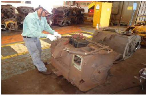
Figura 5 - Teste de isolamento de cabos
