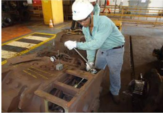
Figura 3 - Desmontagem do motor
