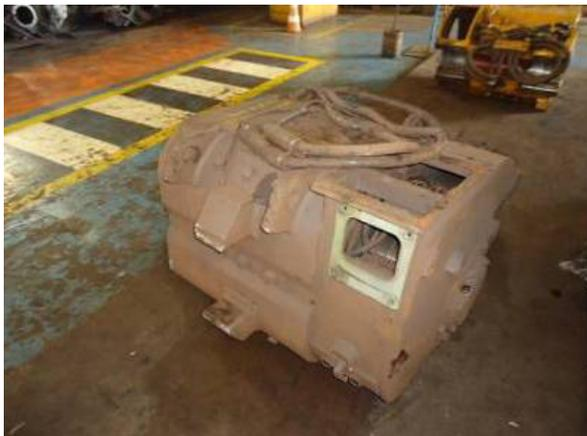
Figura 2 - Motor de tração de locomotiva
