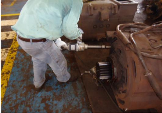
Figura 6 - Desmontagem do motor com chave pneumática
