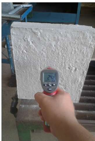
Figura 9 – Extração da temperatura das placas de Argamassa Armada. Fonte: Dados produzidos pelo o autor (2016)
