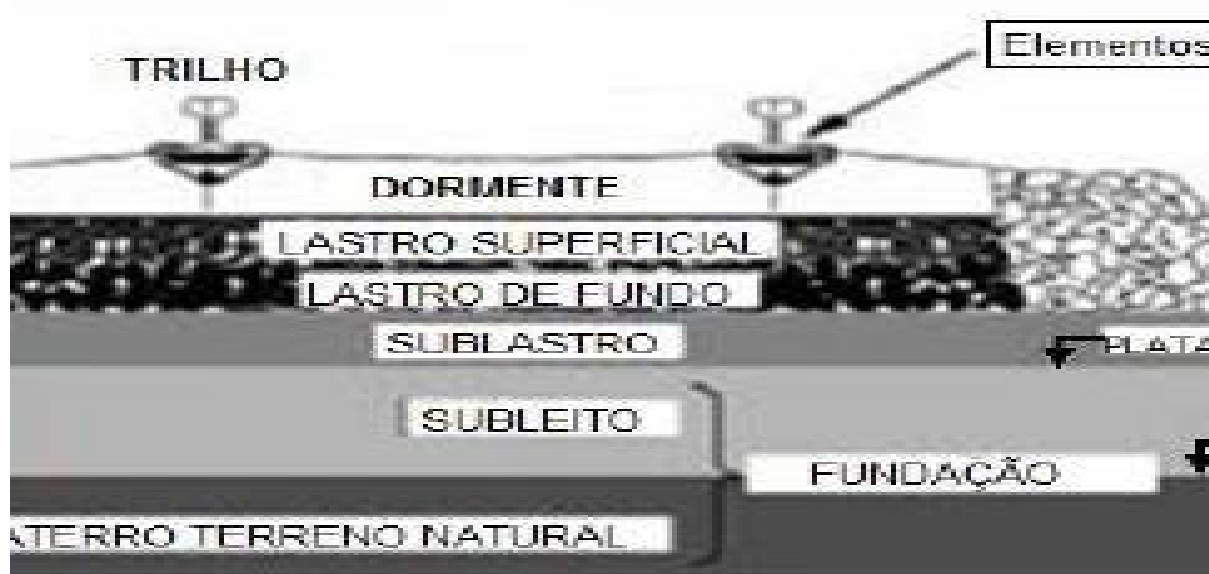
Figura 2 - Composição do pavimento ferroviário Fonte: Delgado (2012)
