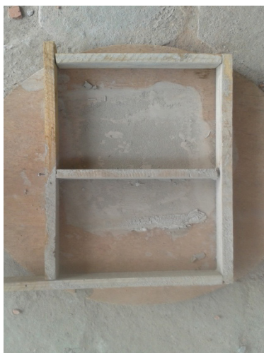
Figura 5 – Fôrmas para confecção das placas de argamassa Fonte: Dados produzidos pelo o autor (2016)
