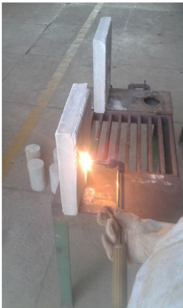
Figura 7 – Aplicação de calor em uma das faces da placa de argamassa Fonte: Dados produzidos pelo o autor (2016)
