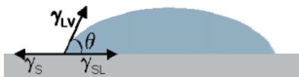
Figura 9 – Hidrofobia em relação à estrutura base Fonte: Araújo (2010)
