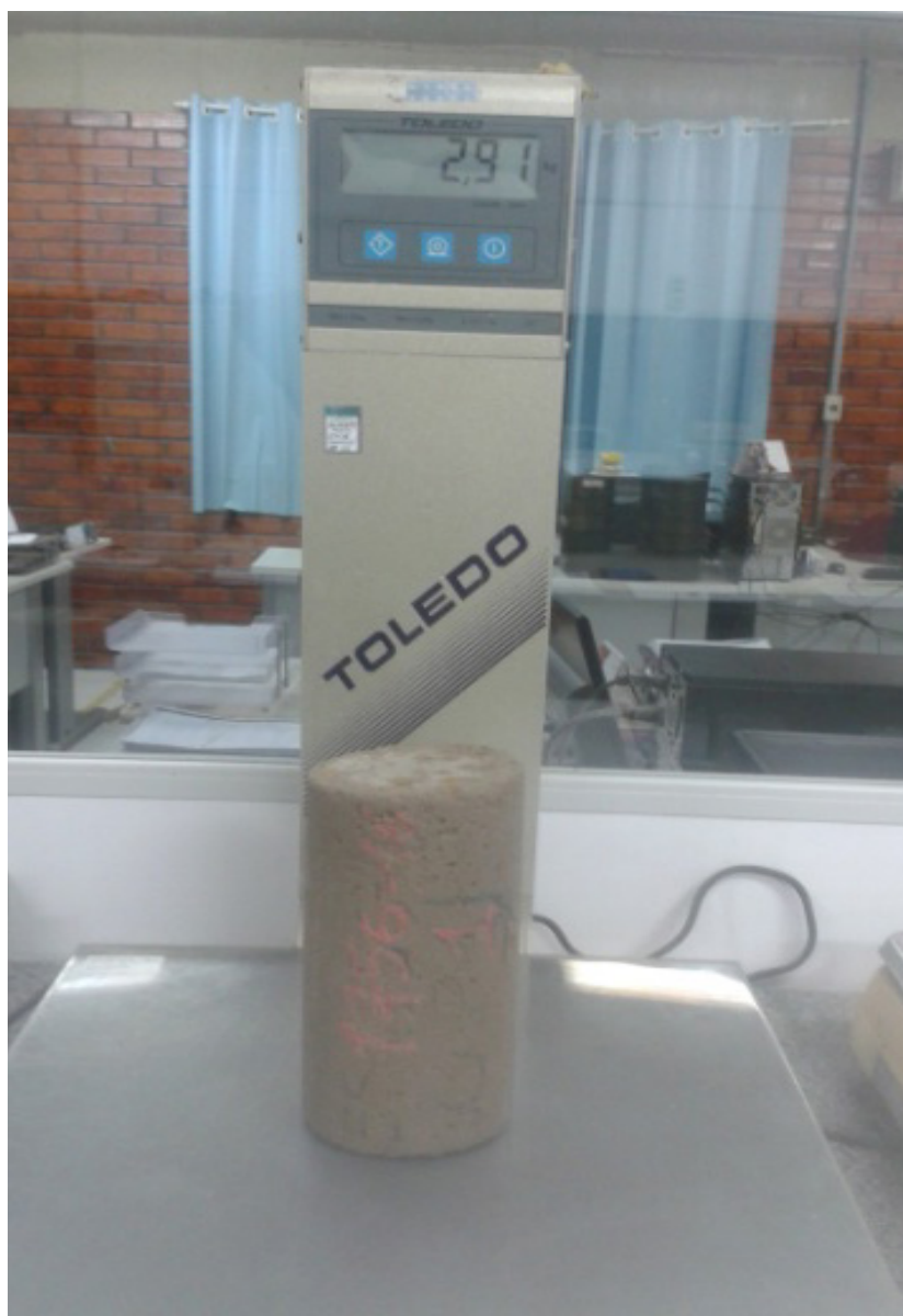
Figura 4 – Pesagem do CP com 3% de adição de Polímeros e Poliuretanos (PU). Fonte: Dados produzidos pelo o autor (2016)
