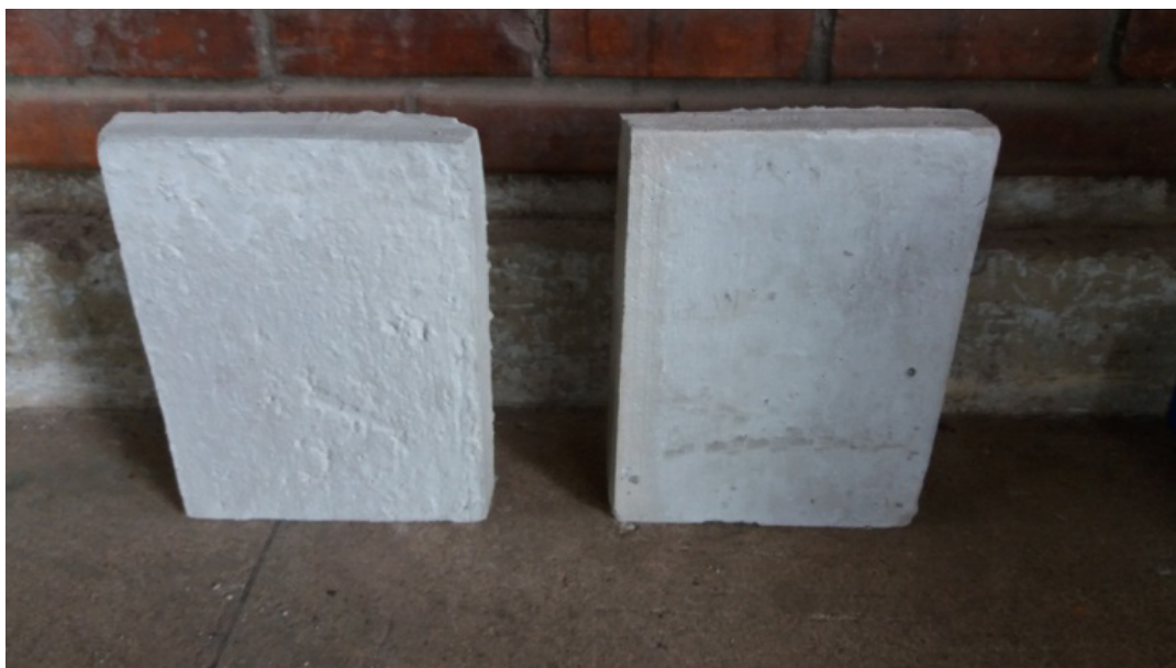
Figura 6 – Placas de argamassa armadas após a desformas Fonte: Dados produzidos pelo o autor (2016)
