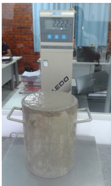
Figura 9 – Determinação da densidade da amostragem de 3% de adição. Fonte: Dados produzidos pelo o autor (2016)
