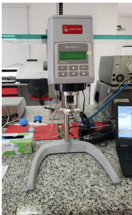
Figura 2. Reômetro ReolabQC (Foto de acervo pessoal).
