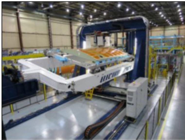
Figura 1 - Rebitadora automática Fonte: Bigoney e Huddleston (2017)
