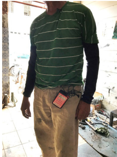
Figura 5: Imagem do funcionário da oficina com o dispositivo de medição de ruído
