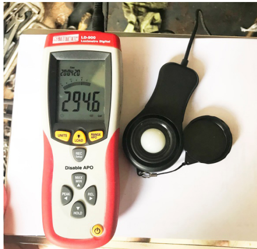
Figura 3: Luxímetro mostrando um dos resultados de iluminância obtidos
