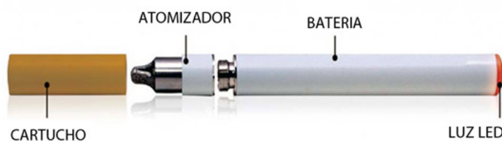
Figura 2 – Estrutura do Cigarro Eletrônico
