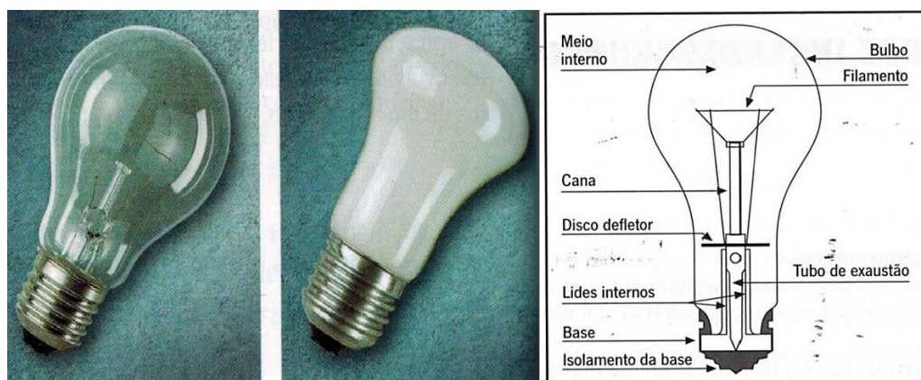
FIGURA 13. Lâmpadas incandescentes e sua estrutura.
