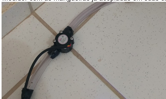
Figura 5 – Medidor com as mangueiras já acopladas em suas extremidades
