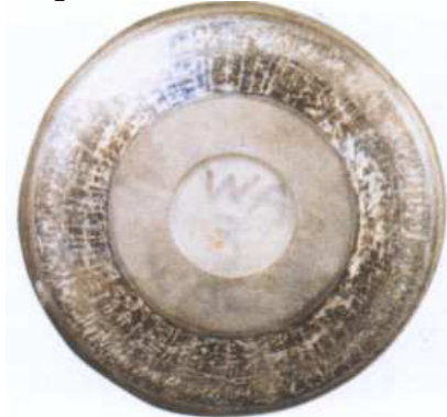
Figura 7- Defeito em rolamento
