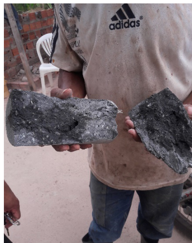
Figura 11: corpo de prova rompido Fonte: Sousa (2017)
