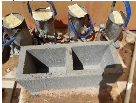
Figura 7: corpo de prova prontos e etiquetados e um bloco estrutural pronto
