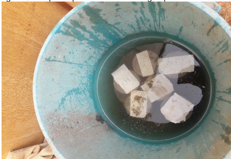
Figura 8 - corpo de provas imersos na água para realizar a cura
