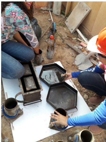
Figura 3: passando óleo queimado nas formas superfície dos blocos
