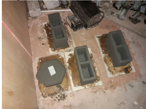
Figura 5: desenformando bloco estrutural
