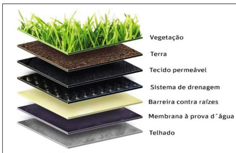
Figura 1. Camadas de um telhado verde.
