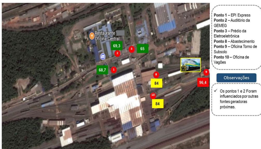
Figura 7 – Mapa de ruído – Teste ao lado da Oficina de Torno de Subsolo
