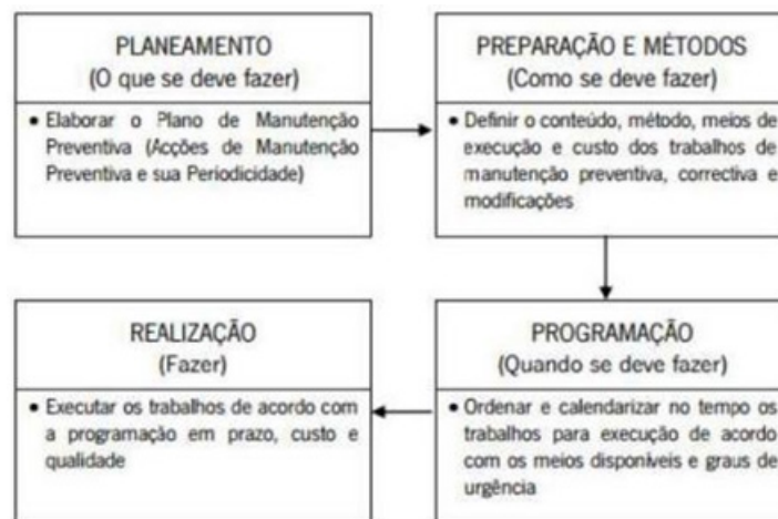
Figura 2. Planejamento e preparação da manutenção
