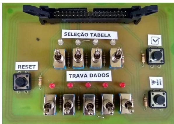
Figura 4 - Placa responsável pela comunicação dos jogadores com a máquina
