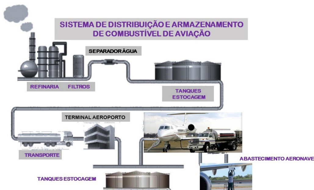
Figura 2. Visualização do sistema de armazenamento e distribuição de combustíveis de aviação, da refinaria ao tanque da aeronave. (Fonte: https://www.wipro.com/en-CN/engineeringNXT/solving-aviation-fuel-complexities-through-hyper-spectral-imagin/ modificado)
