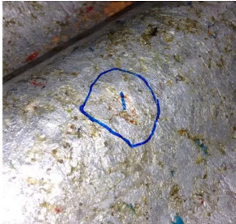
Figura 36 - Impacto de corpo duro de 2,5 J em Telha Ecológica
