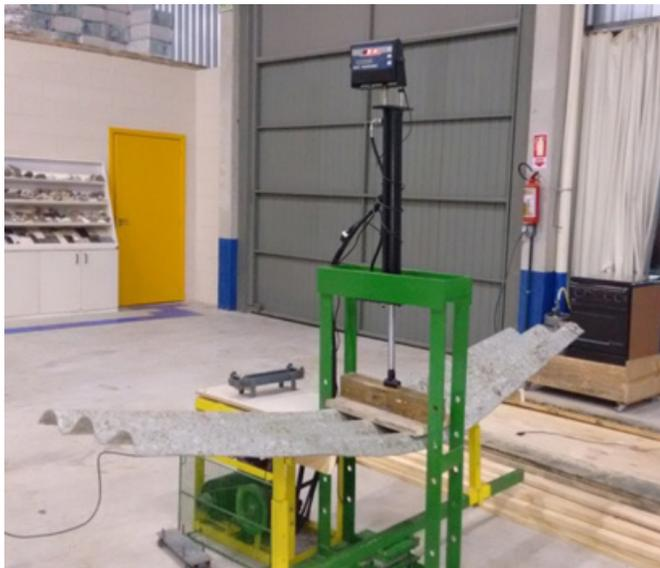
Figura 40 - Ensaio de flexão em telha ecológica
