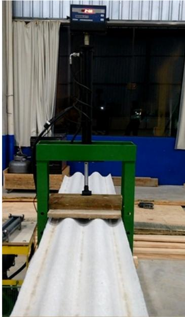
Figura 38 - Ensaio de flexão em telha de fibrocimento e amianto
