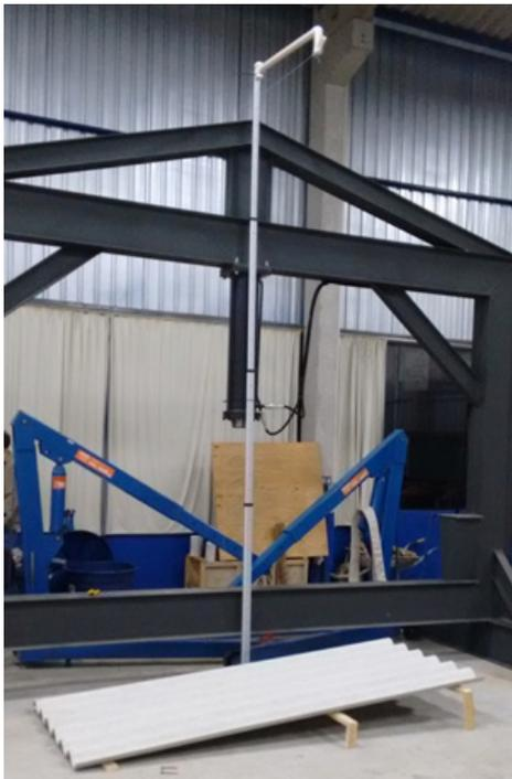
Figura 35 – Ensaio de resistência ao impacto de corpo duro – estrutura de ensaio
