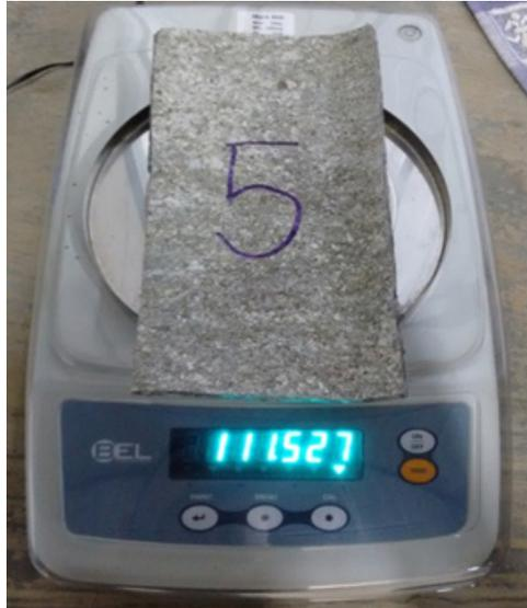
Figura 32 - Pesagem de amostra de telha ecológica
