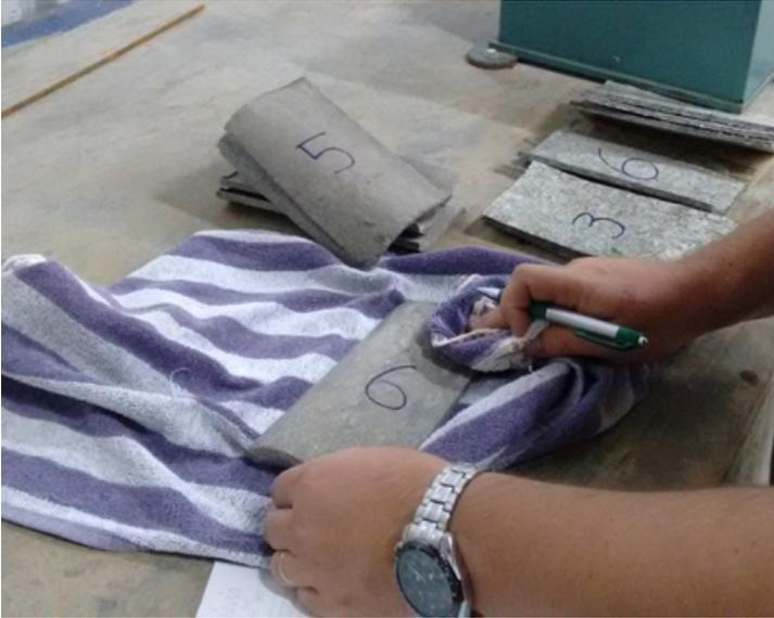
Figura 30 - Secagem superficial das amostras para pesagem
