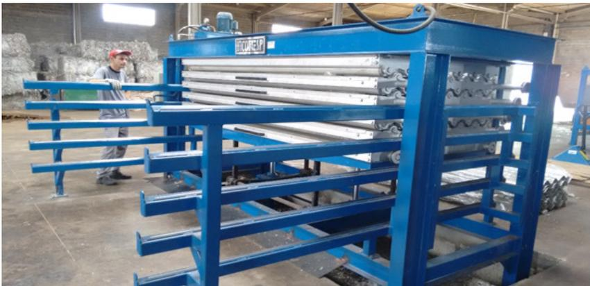
Figura 22 - Prensagem a frio - prensa onduladora
