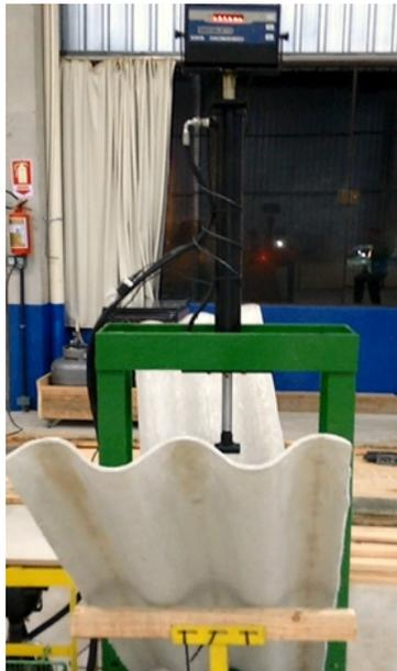
Figura 39 - Telha de Fibrocimento após o rompimento
