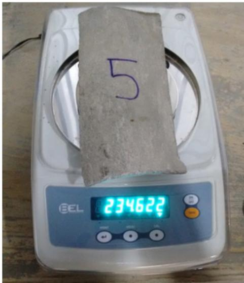
Figura 31 - Pesagem de Amostra telha de fibrocimento
