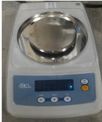
Figura 28 - Balança de precisão BEL
