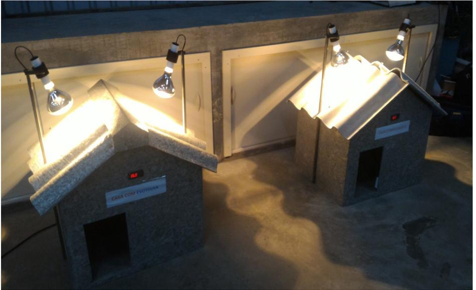
Figura 34 – Modelo de casas para avaliação de desempenho térmico – durante ensaio
