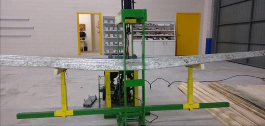
Figura 41 - Ensaio de flexão em telha Ecológica - Deformação plástica
