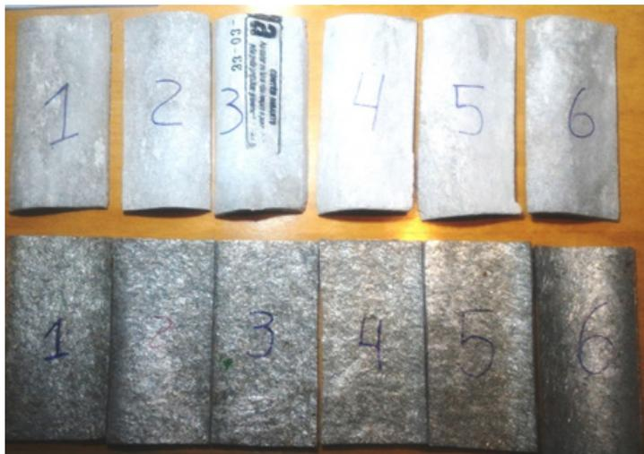
Figura 29 - Amostras usadas no ensaio de absorção de água
