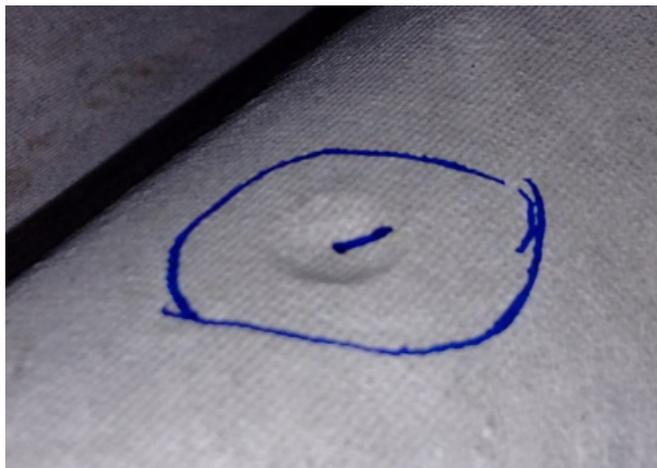
Figura 37 - Impacto de corpo duro de 2,5 J em telha de fibrocimento e amianto
