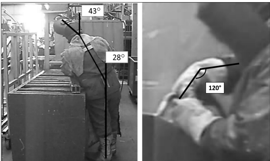
Figura 5 – Ângulos de posições de trabalho do soldador.
