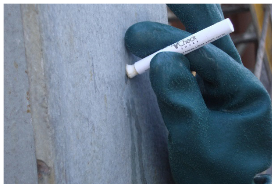
Figura 7 - Aplicação do Swab Lead Check
