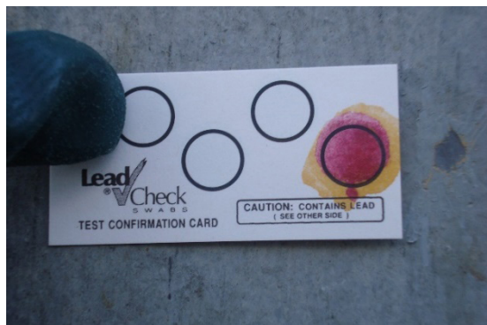
Figura 8 - Verificação do funcionamento do Swab no cartão
