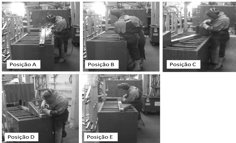
Figura 4 – Posições de Trabalho do Soldador.
