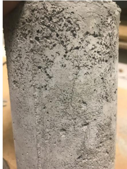
Figura 5 – Amostra com adição de 5% de cinza
