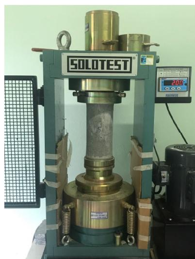
Figura 2 - Corpo de prova comprimido pela prensa servo hidráulica Solotest.
