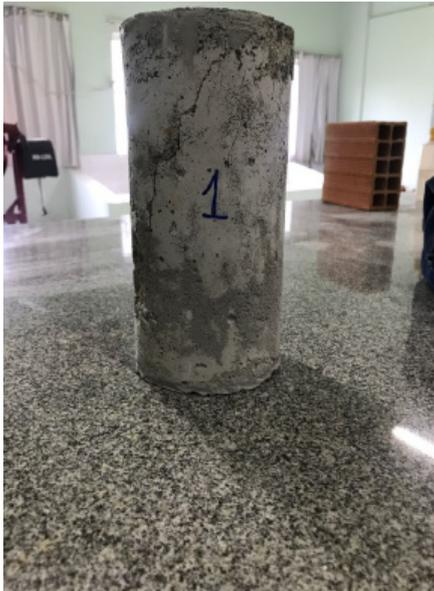
Figura 4 – Amostra de concreto de referência
