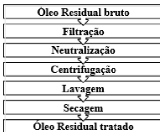
Figura 1 - Fluxograma do tratamento do óleo residual bruto Fonte: Autores
