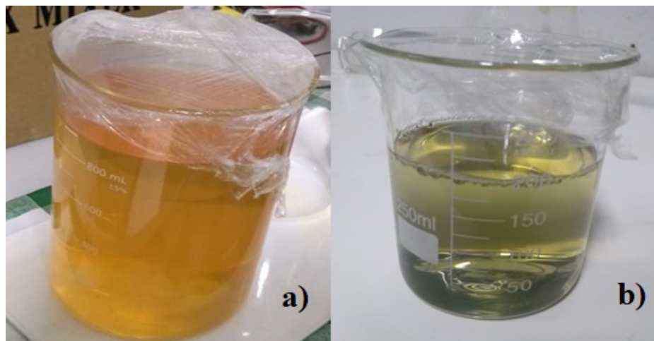
Figura 4 – a) Efluente sintético antes do tratamento; b) efluente sintético após o tratamento Fonte: SOUTO et al. (2019)
