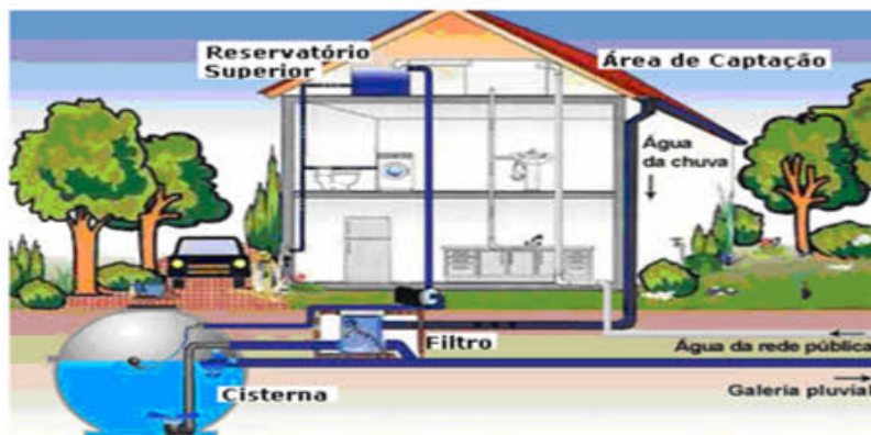
Figura 1 - Esquema de sistema aproveitamento de água de chuva Fonte: Bella Calha (2007)
