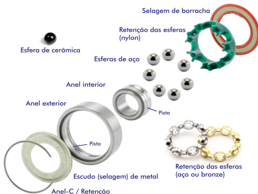
Figura 1: Componente explodida de um rolamento
