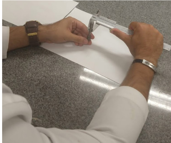
Figura 1: Medições do diâmetro de um corpo de prova cilíndrico reduzido.
