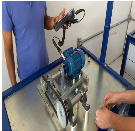
Figura 2 – Medição de vibrações na bancada B
