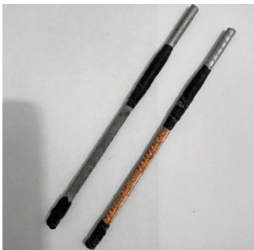
Figura 12 - Barras desalojadas dos corpos de prova Fonte: Acervo do autor (2018)
