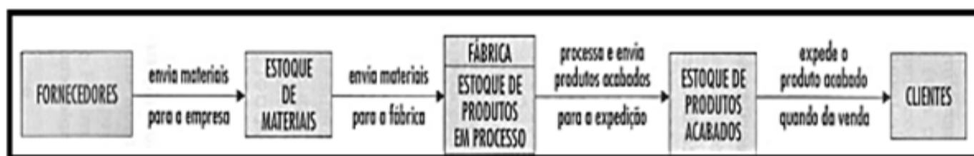
Figura 3 - Fluxo produtivo num sistema tradicional com geração de estoque Fonte: Padoveze (2004)
