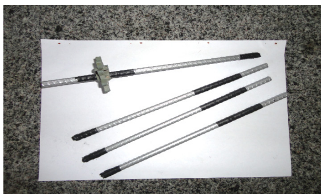
Figura 1- Esquema de delimitação das zonas de exposição das barras Fonte: Acervo do autor (2018)
