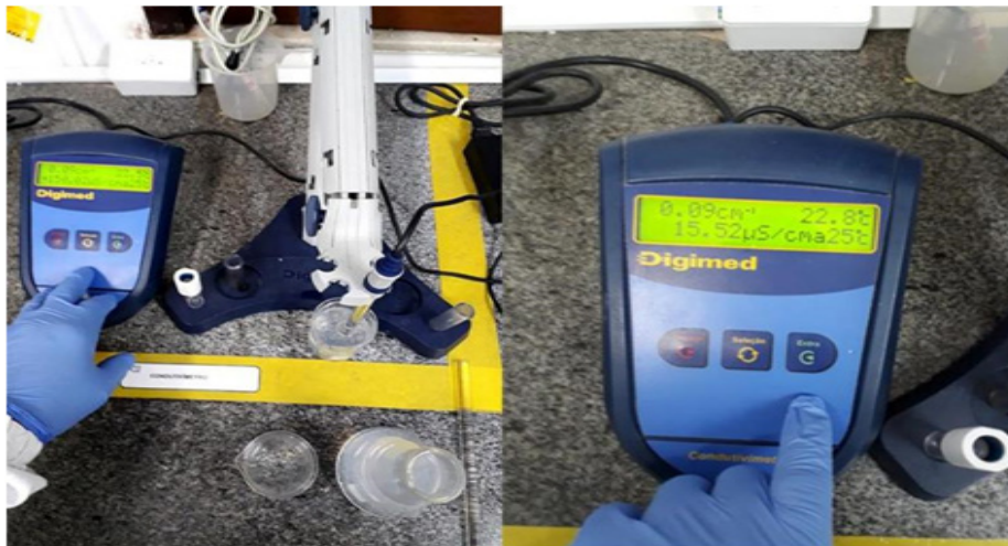
Figura 6- Medição de condutibilidade da solução Fonte: Acervo do autor (2018)
