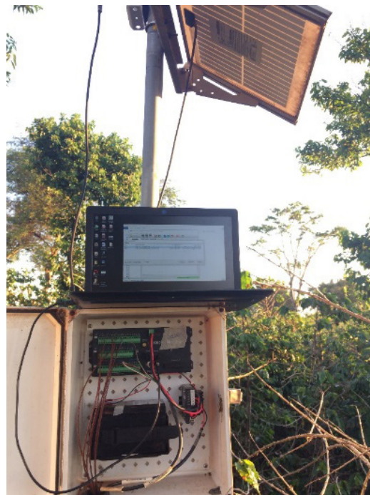
Figura 3: Coleta dos dados em DATALOGGER Fonte: os autores (2020)
