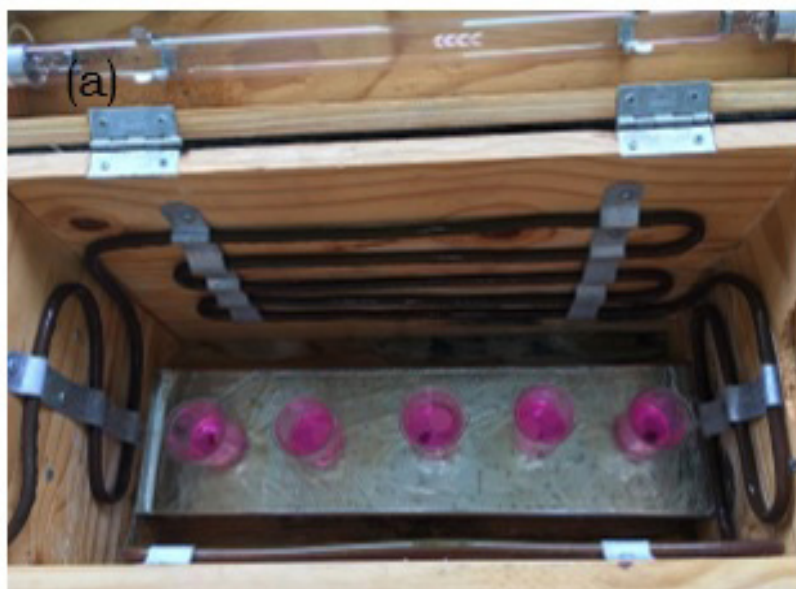
Figura 7 – Amostras com solução de 5mg.L-1 de RhB no reator fotocatalítico Fonte: Autores (2019)
