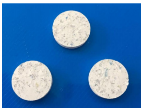
Figura 2 – Amostras após prensagem uniaxial a 671,82 kgf/cm 2 Fonte: Autores (2019)
