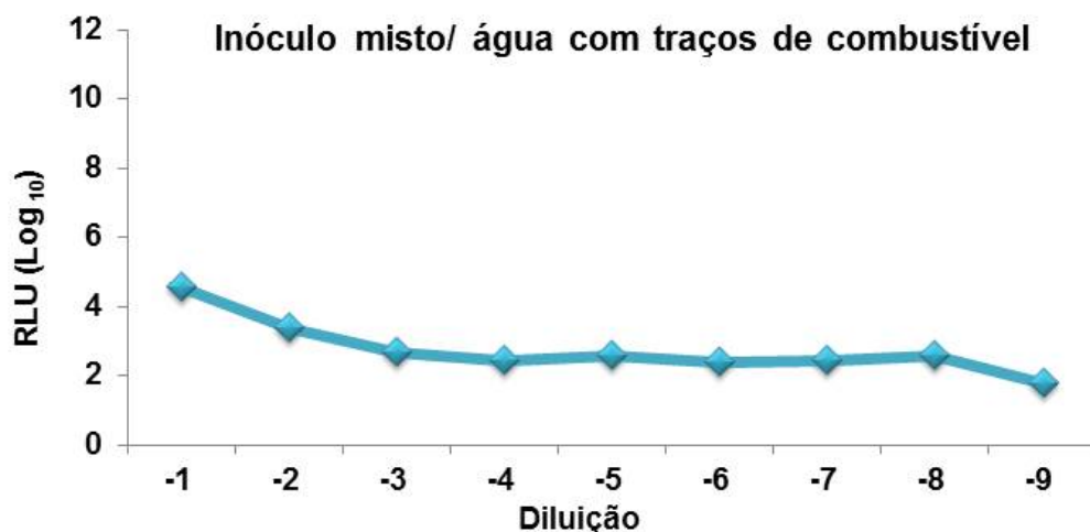
Figura 5. Valores de RLU ( \log_{10} ) obtidos para leituras de diluições de um inóculo não caracterizado em água que esteve em contato com combustível por 30 dias; CV=46%; Background: 30 RLU / CV = 25%.
