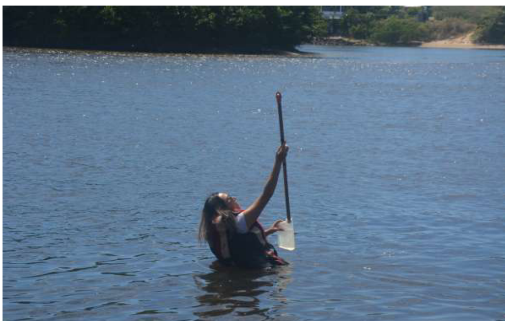
Foto 1- Procedimento de coleta de amostra de água em P5. Fonte: Site da Universidade Estadual do Ceará (2019)
