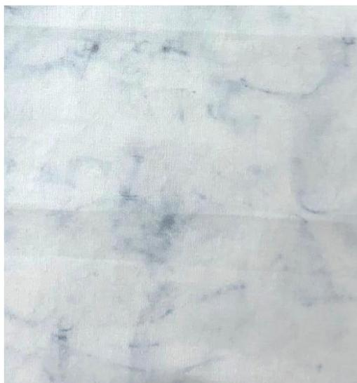
Figura 3 – Efeito marmorizado da amostra tingida com corante reativo utilizando água do mar.
