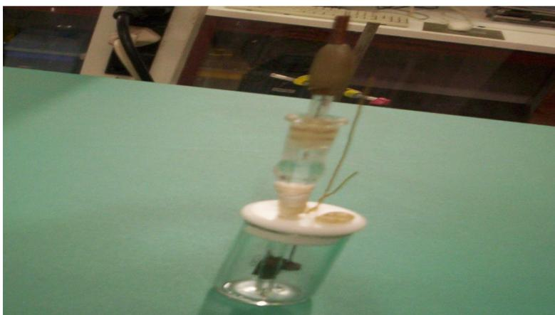
**Figura 22:** Célula eletroquímica utilizada no preparo das amostras para análise cromatográficas.
