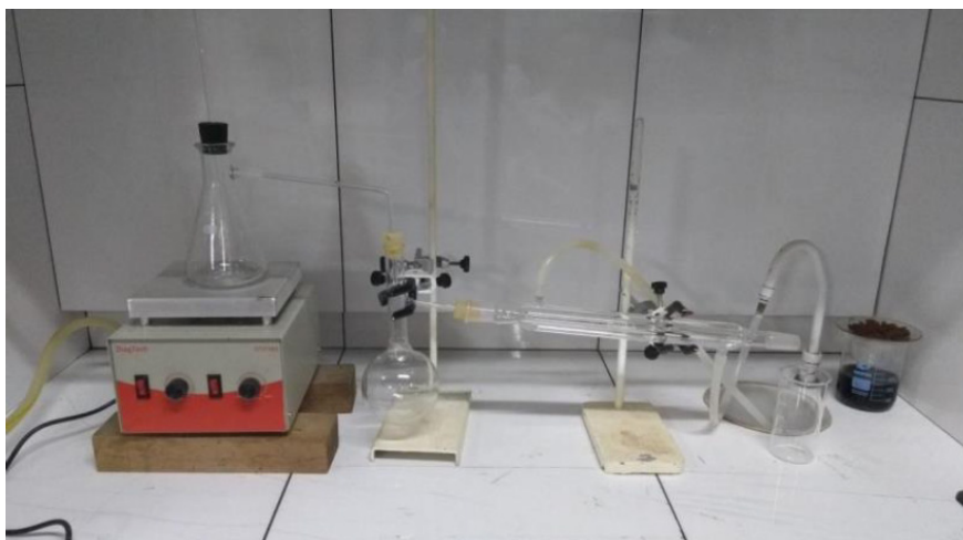
Figura 1 Configuração da instrumentação do método de destilação por arraste a vapor.
