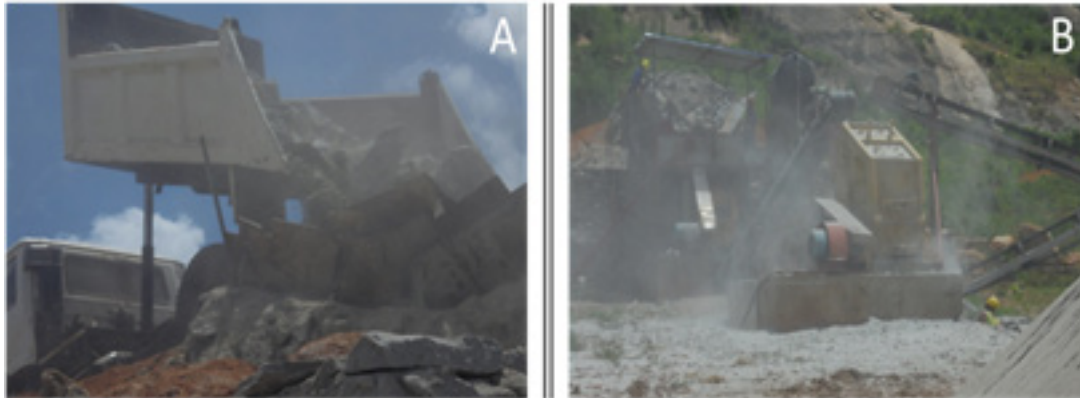
Figura 7. Condições ambientais após a extração. Poeira proveniente de: A – Perfuração, desmonte e acumulação de rejeito. B – Beneficiamento da rocha.
