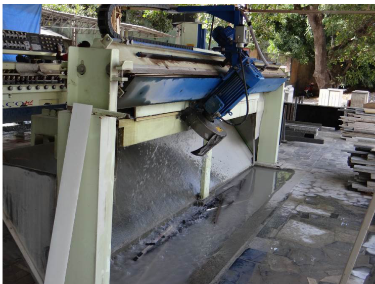
Figura 1 – Processo de acabamento com umidificação
