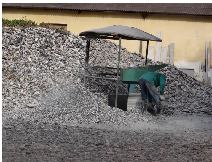
Figura 2 – Transformação do resíduo em agregado/brita para a construção civil
