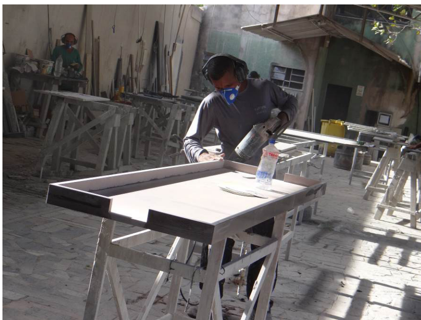
Figura 16 – Funcionário trabalhando sem a proteção para os olhos
