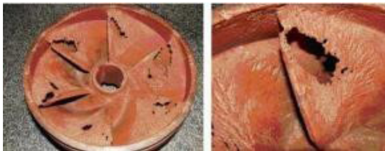
Figura 3 – Demonstração do impacto causado pela cavitação. Fonte: MMtec Inspeções Industriais (2016)
