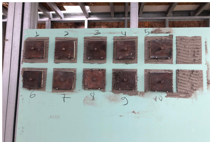
Figura 6 - Pastilhas de aço coladas nas placas cerâmicas Fonte : Autores (2019)
