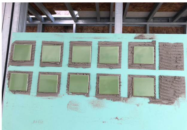
Figura 4 - Placas cerâmicas assentadas sobre a chapa RU Fonte : Autores (2019)
