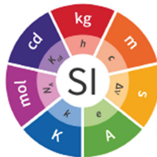
Figura 1 – SI Illustration , Representação gráfica do Novo SI incluindo as unidades de base e as correspondentes constantes fundamentais que as definem Fonte: BIPM (BIPM, 2018a)
