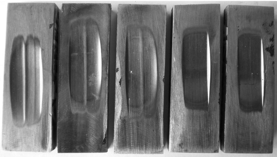
Figura 32 - Região soldada com eletrodo E6-UM-60R após desgaste Roda de Borracha.
