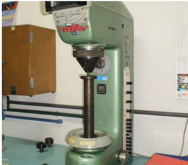
Figura 26 - Equipamento HECKERT para ensaio de dureza.
