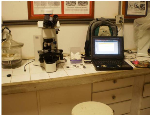
Figura 29 - Equipamento para ensaios metalográficos.
