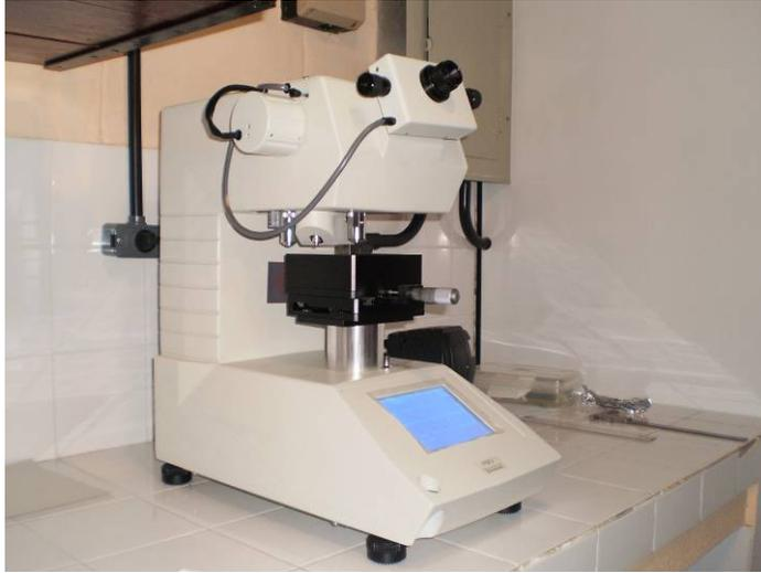
Figura 25 - Equipamento SHIMADZU HMV2000 para ensaio de microdureza Vickers.
