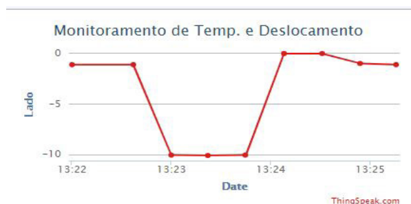
Figura 2.3 - Aferição do deslocamento do paciente pelo acelerômetro ADXL345 Fonte: Própria (2019)
