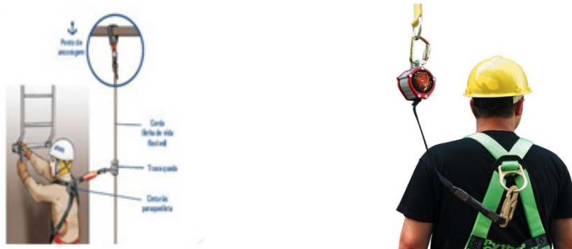
Figura 1 – Trava-queda para linha flexível/retrátil Fonte: EPI (2016).
