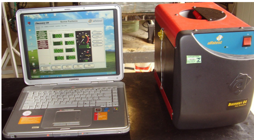
Figura 5 - Sistema de análise de gases de combustão. Fonte: O Autor
