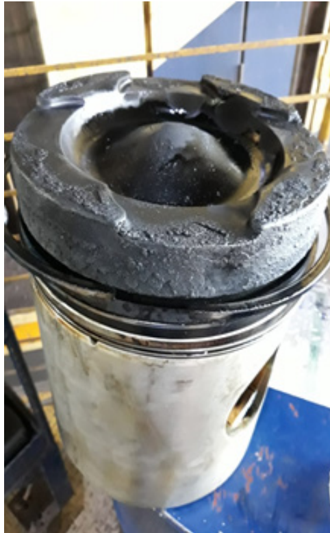
Figura 5. Foto do Pistão com o Anel de Compressão Quebrado. Fonte: Autor (2019).
