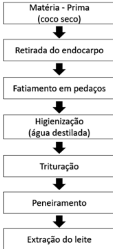
Figura 3. Fluxograma do processo de extração da farinha do coco. Fonte: Autor, (2019)
