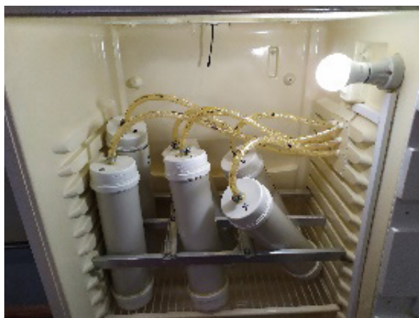
Figura 5 – Parte inferior do sistema de biodigestão com reatores de 3 litros Fonte: Autores (2021)
