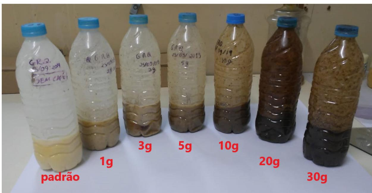
Figura 2 - Sabão, nas garrafas PET, da esquerda para direita, sabão padrão sem borra de café e com borra de 1g, 3g, 5g, 10g, 20g e 30g, respectivamente
