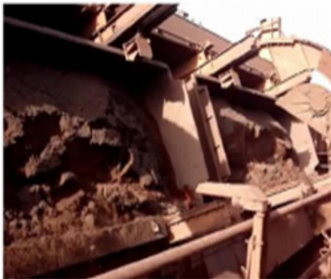
O VV ao executar o movimento de rotação, a carga dos vagões é transferida para os silos, conforme ilustrado na Figura 2, que é direcionada para uma rota operacional que é composta dos seguintes equipamentos: VV; alimentadores de esteiras de aço (AL); correias transportadoras (CT) e empilhadeiras (EP) que executam o empilhamento da carga no pátio de estocagem.
