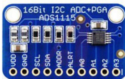
Figura 5 – Conversor analógico/digital ADS1115 16 bits com amplificador de ganho programável.
