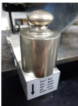
Figura 11 – Massa padrão utilizada para calibração do sistema de medição de torque.
