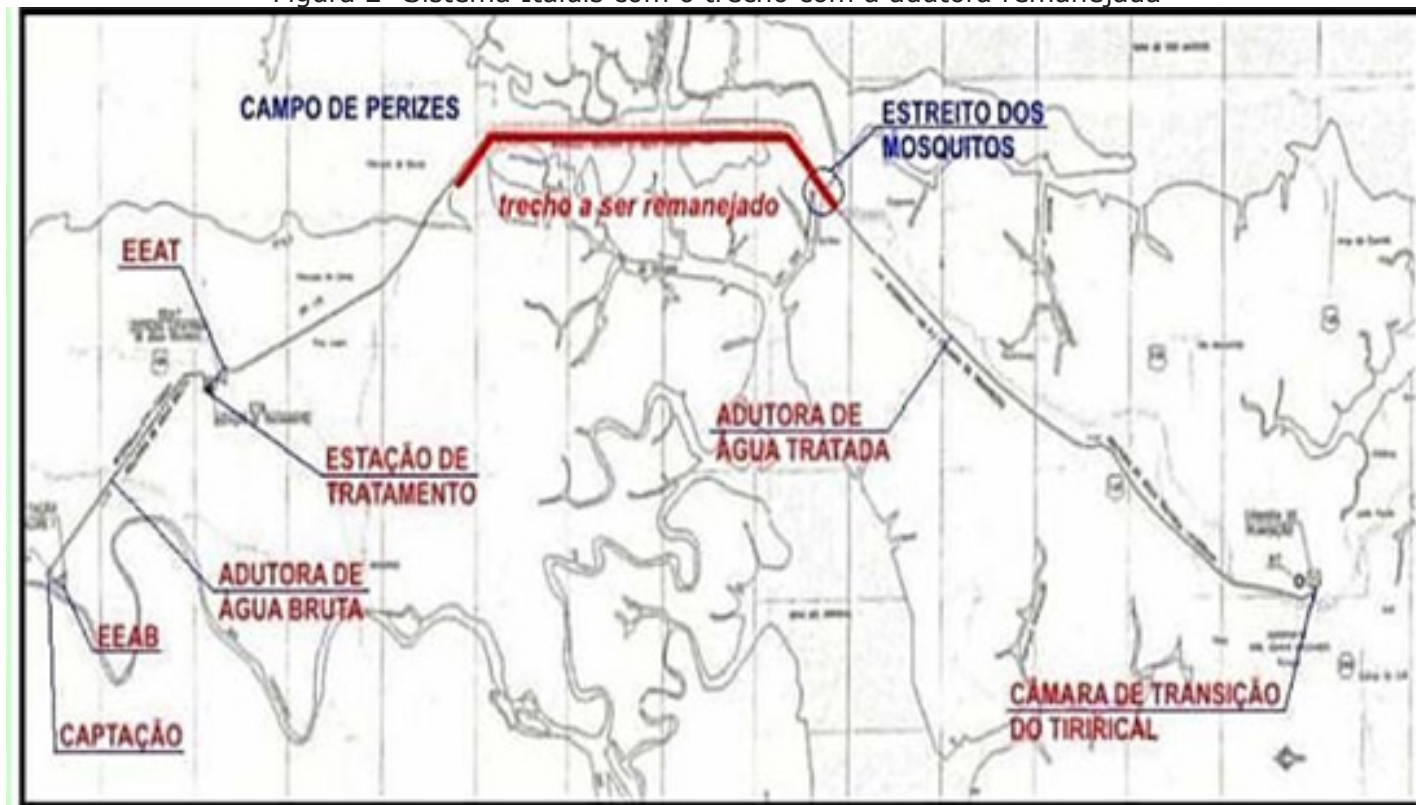
Figura 2- Sistema Italuís com o trecho com a adutora remanejada
