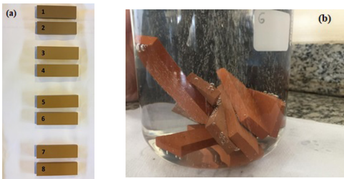
Figura 1: (a) Barrinhas após queima a diferentes temperaturas e (b) Durante imersão em água, indicando a presença de bolhas devido à elevada porosidade
