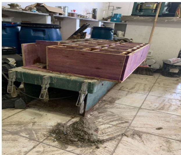
Figura 3 – Fôrma de madeirite sobre a mesa vibratória Fonte: Autora (2021)
