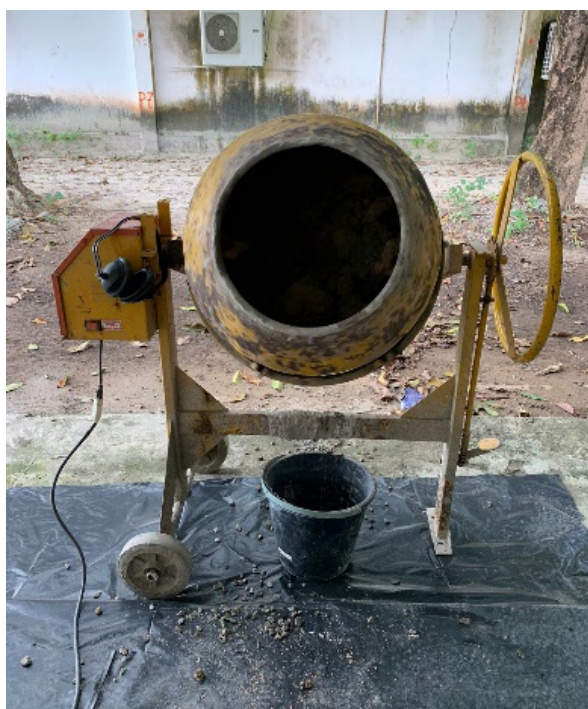
Figura 2 – Betoneira utilizada para preparação do concreto Fonte: Autora (2021)
