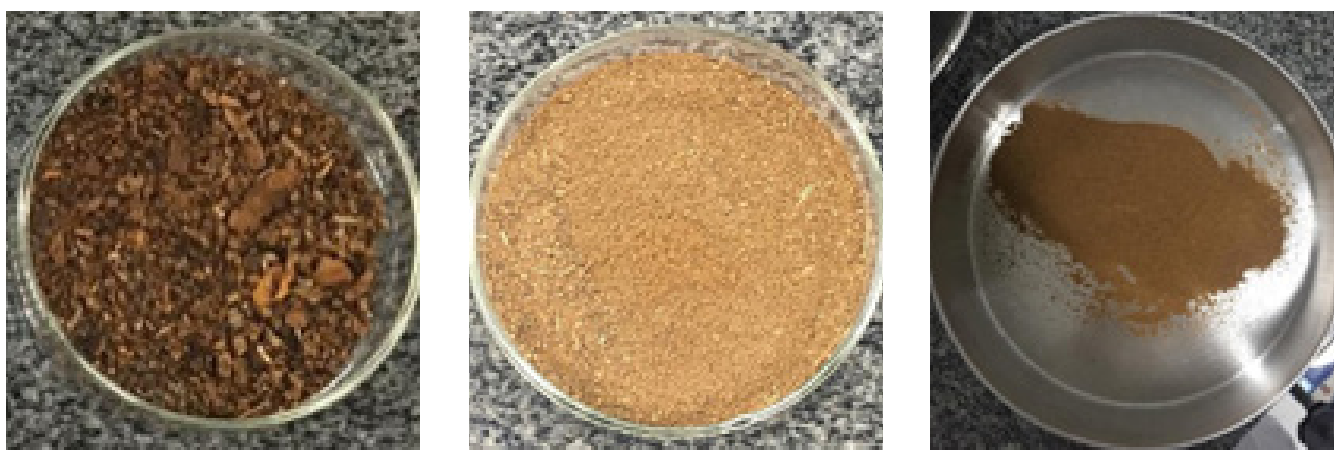
Figura 7 – Cascas de banana após trituração em liquidificador, almofariz e agitação na peneira Fonte: Autores (2021)
