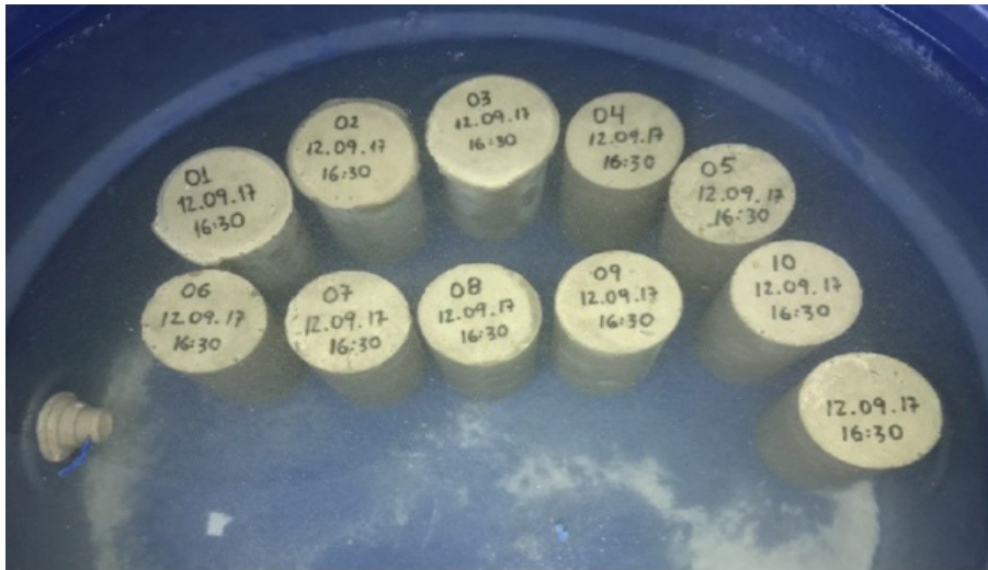
Figura 6 - Cura dos corpos de prova Fonte: Autor (2018)
