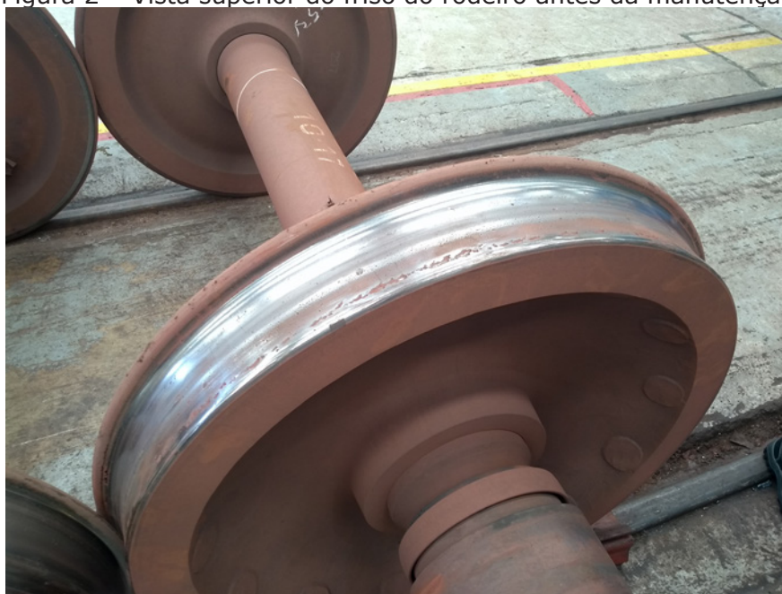
Figura 2 – Vista superior do friso do rodeiro antes da manutenção
