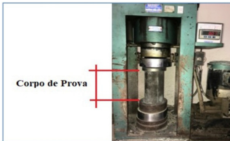
Figura 7 - Prensa hidráulica – compressão axial Fonte: Autor (2018)
