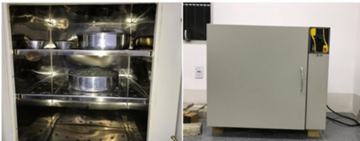
Figura 1 - Estufa para secagem de agregados graúdos Fonte: Autor (2018)
