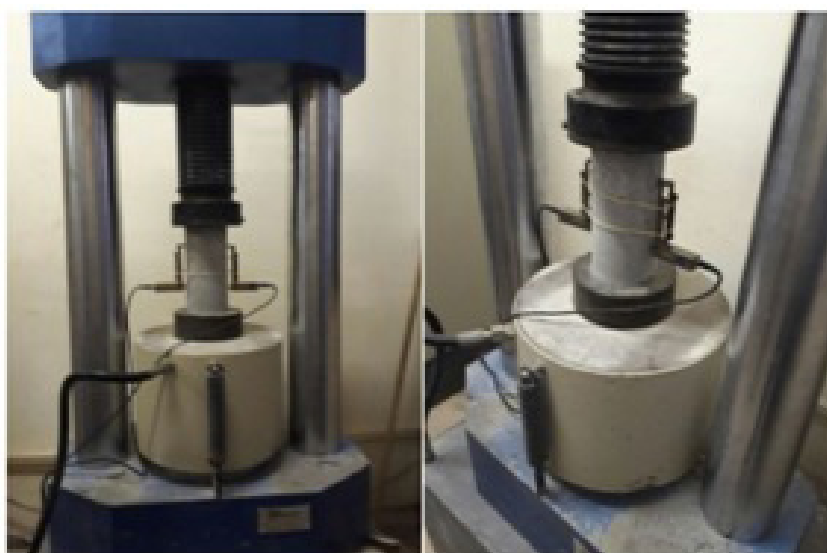
Figura 8 - Prensa hidráulica - compressão axial Fonte: Autor (2018)
