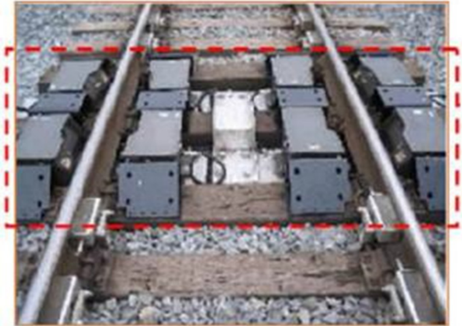
Figura 3 – Sistema de monitoramento de rodeiros
