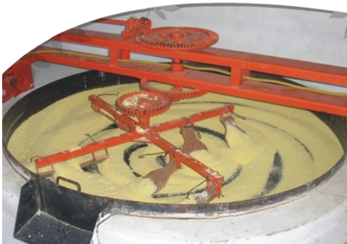
FOTO 24. Torragem no forno rotativo.
