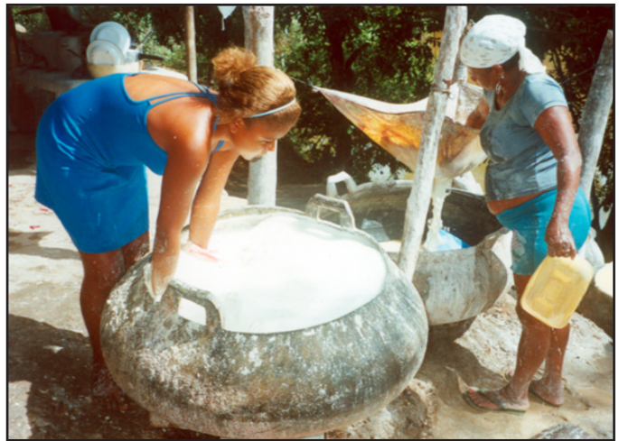
FOTO 20. Processo manual de extração da fécula
