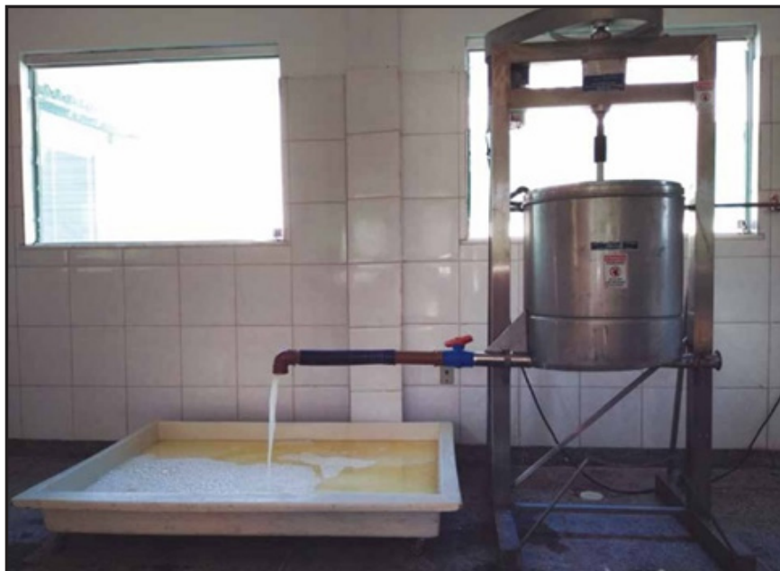
FOTO 21: Extração mecânica da fécula.
