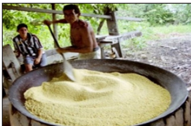
FOTO 28. Processo de torragem manual.
