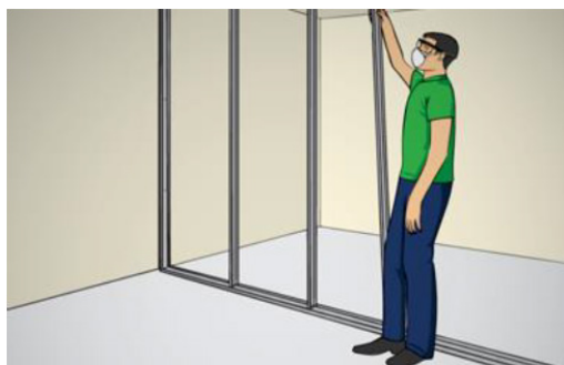
Figura 4 – Instalação dos montantes Fonte: Marinho e Cavalcante (2017)
