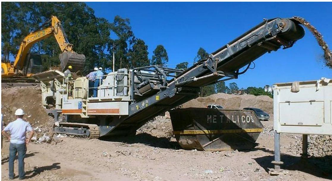
Figura 3 – Unidade recicladora de concreto endurecido
