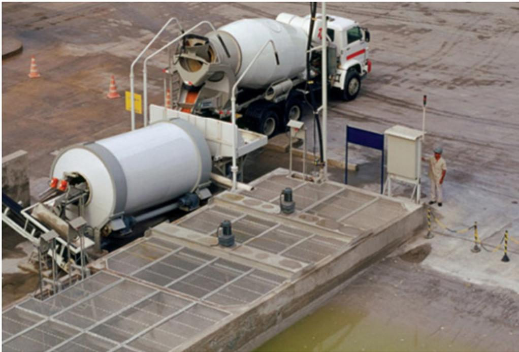
Figura 2 – Unidade recicladora de concreto fresco
