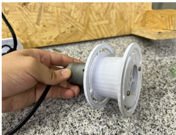
Figura 10. Roda para puxar o Filamento
