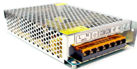
Figura 5. Fonte Chaveada de 12V 10A 120W
