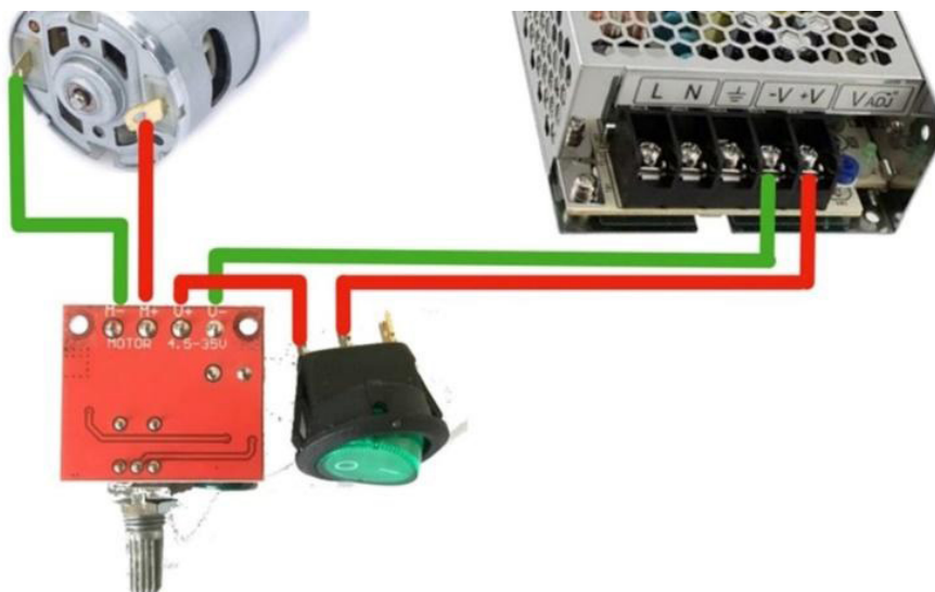
Figura 14. Ligação do Motor com o Controlador de Velocidade
