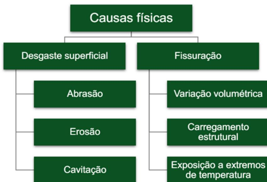
Figura 1. Causas físicas da deterioração do concreto
