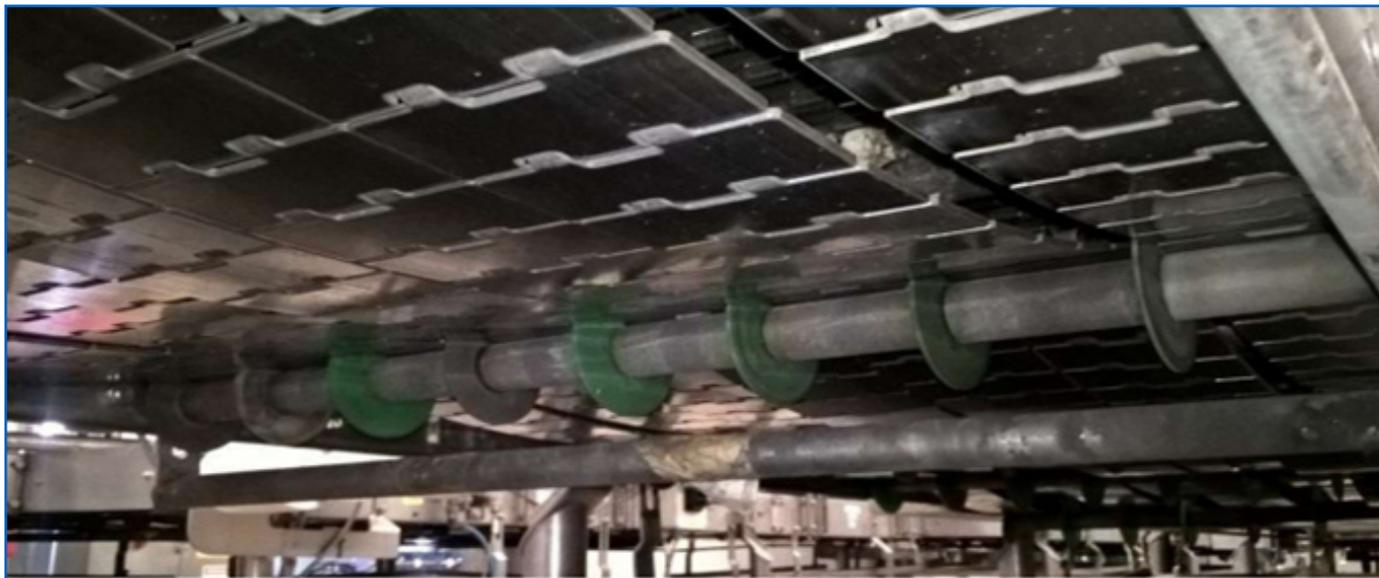
Figura 4. Divisórias das esteiras de saída do inspetor recolocadas
