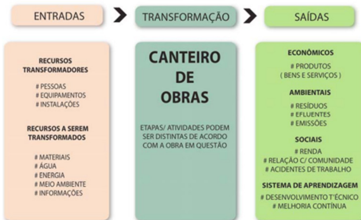
Figura 2. Processamento no canteiro de obras
