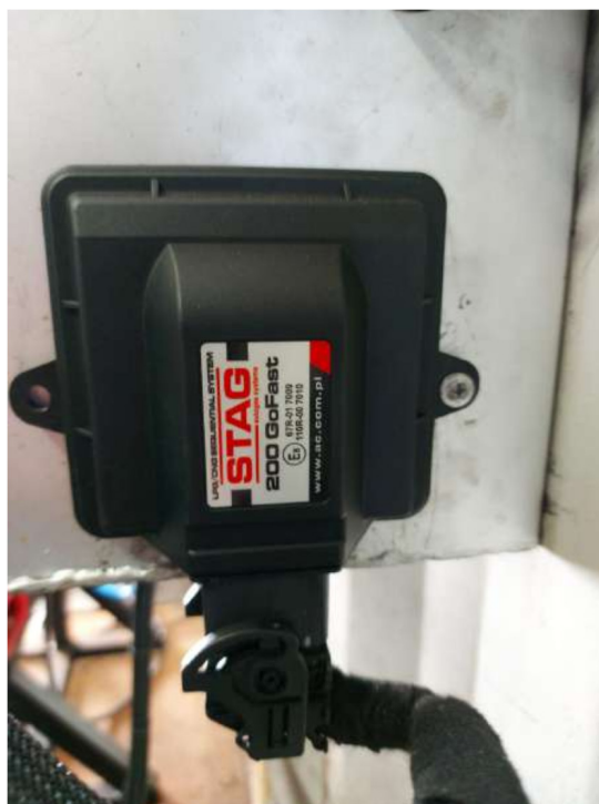
Figura 4. Unidade de controle eletrônico do “Kit Gás”
