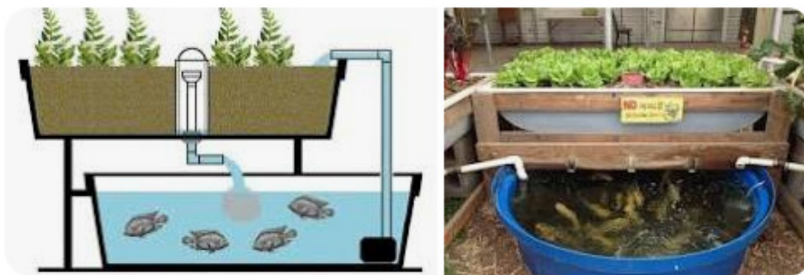
Figura 2. Esquema de sistema de aquaponia em escala doméstica
