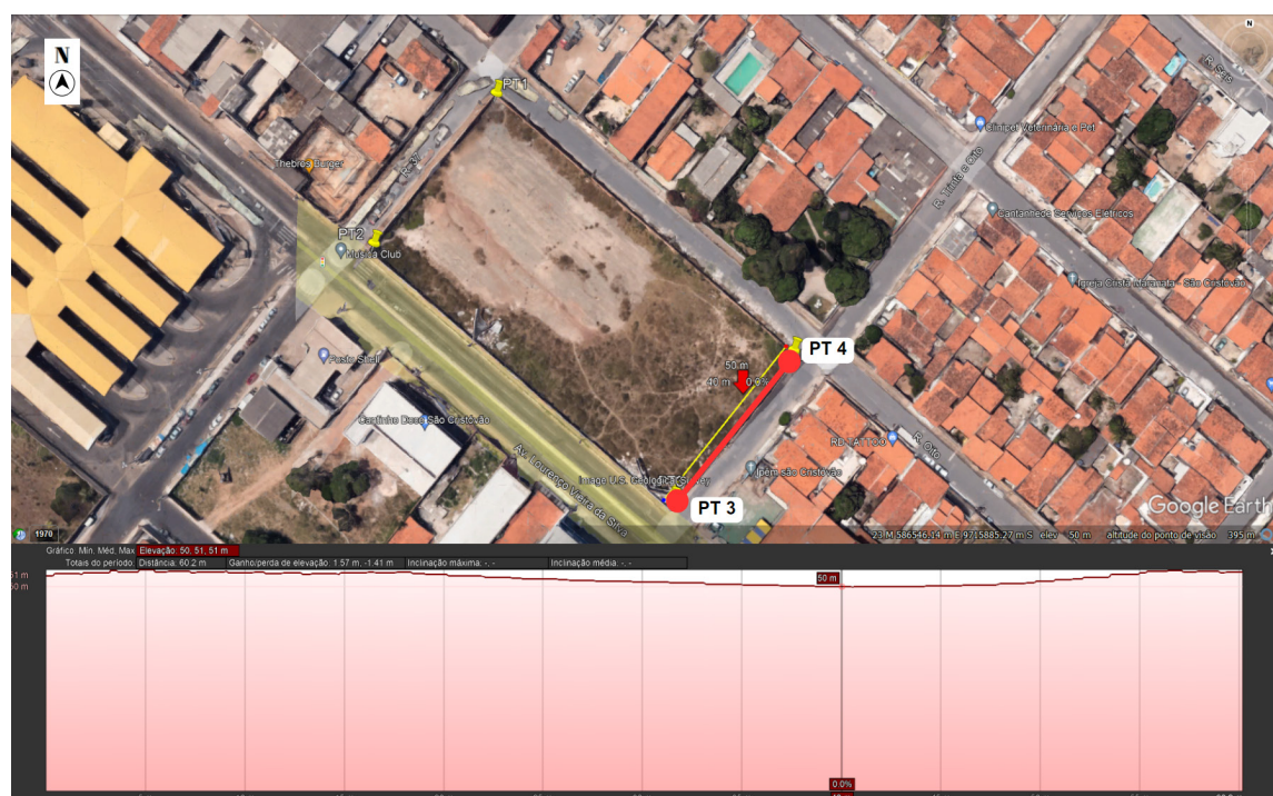
Figura 10. Declividade transversal do lote de intervenção.
