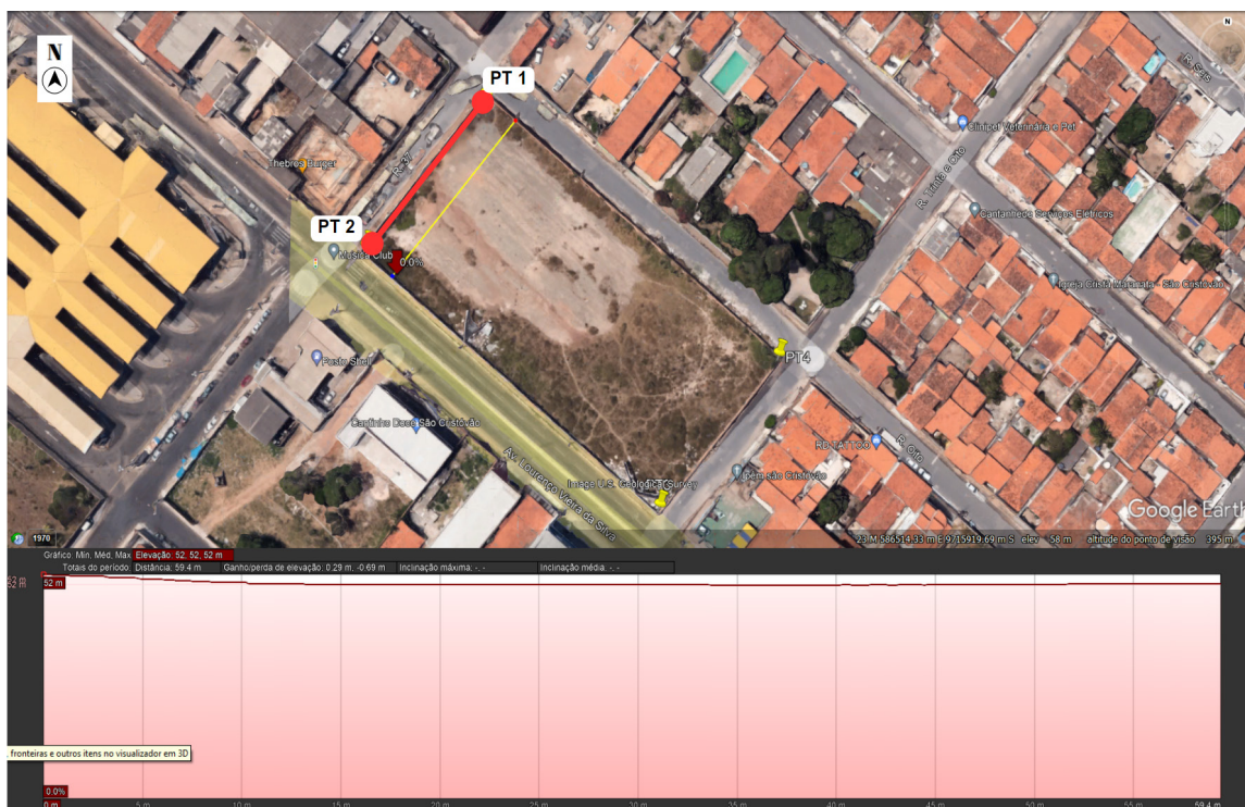
Figura 9. Declividade transversal do lote de intervenção.
