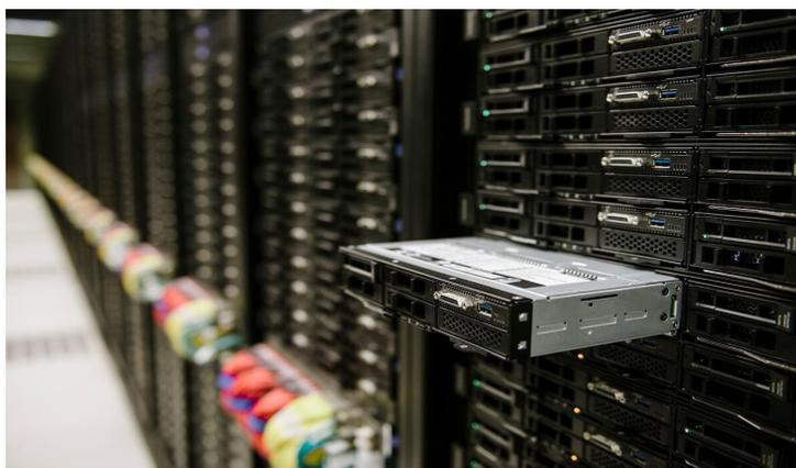
**Figura 2:** Um Equipamento de TI sendo colocado no raque
