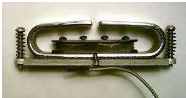
FIGURA 1: Captador “Ferradura”, criado por Beauchamp e Rickenbacker FONTE: BIZZO (2015)
