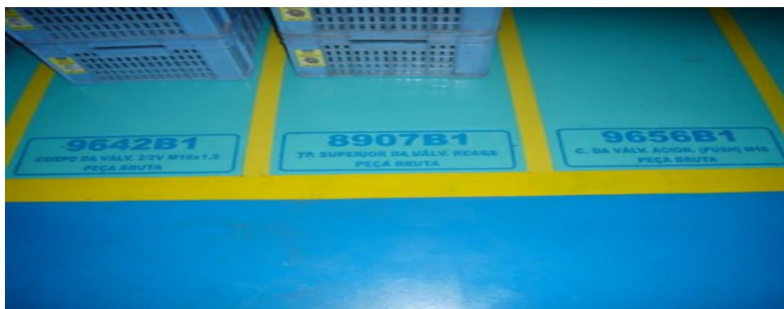
Figura 1 - Demarcação no piso
