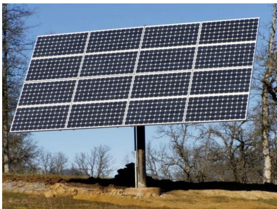
Figura 5: Rastreador Solar Fotovoltaico – Wattsun Solar Tracker AZ-125
