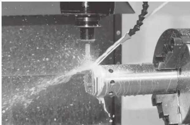
Figura 2 - Peça lubrificada com fluido refrigerante durante usinagem
