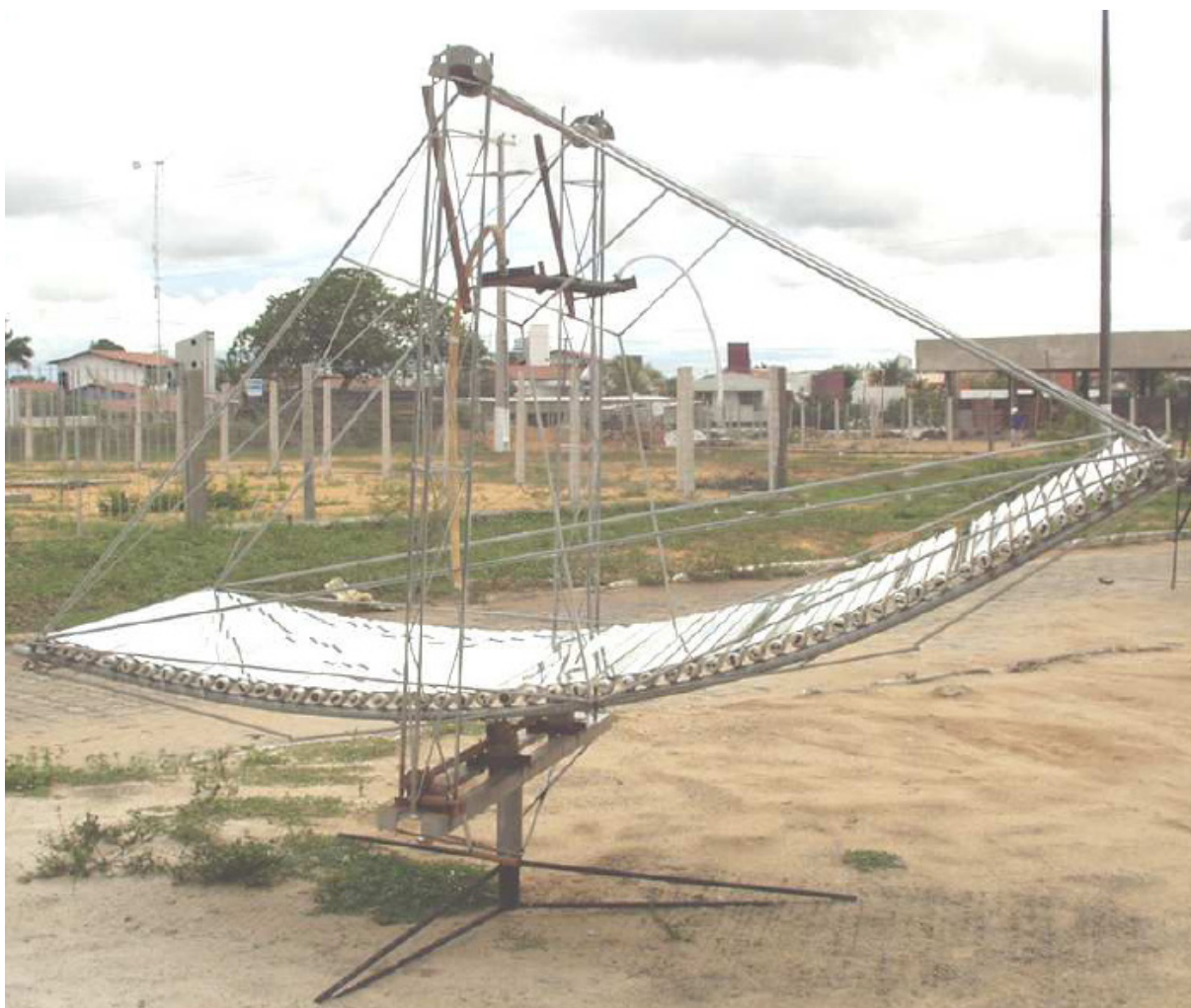
Figura 9: Concentrador solar projetado com mecanismo de rastreamento
