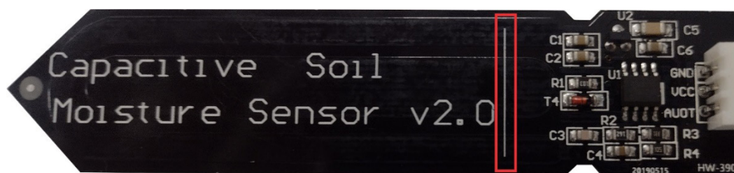
Figura 5. Sensor SKU:SEN0193, com destaque em vermelho à faixa limite de profundidade do sensor.
