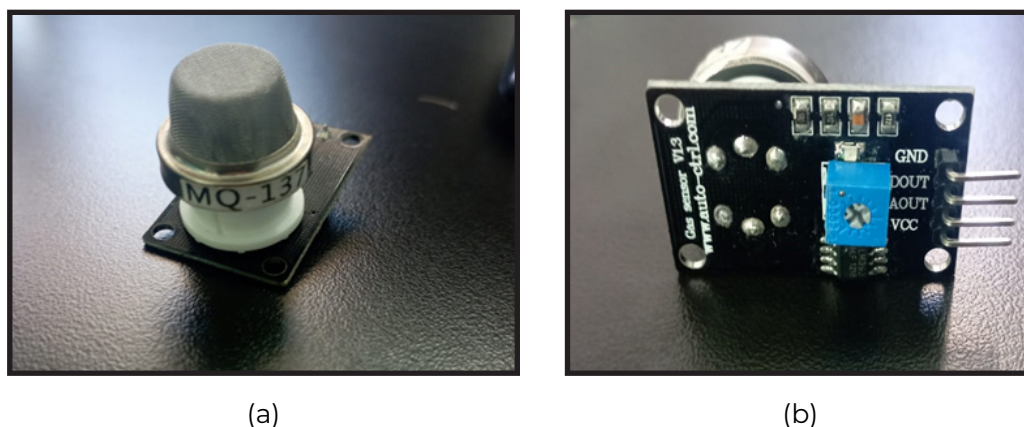
Figura 6. (a) Sensor MQ137 e (b) Placa e componentes do circuito do sensor MQ137.
